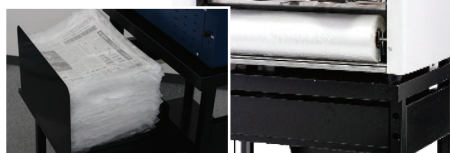
雨の日や雨が降りそうな日に、新聞と折り込みチラシが濡れないようビニールでラッピングしてくれる新聞包装機。
